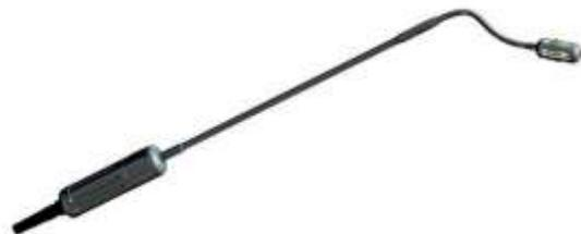
HEAD VISOR Probe(Code 7523)は、VMA Vで低域成分の検出に活躍します。HEAD VISORプローブ先端の2つのマイクが測定対象物の表面から発せられる音とその音源の正確な位置を検知します。HEAD VISORプローブ自体の位置はVMA Vカメラがトレースし記録します。
