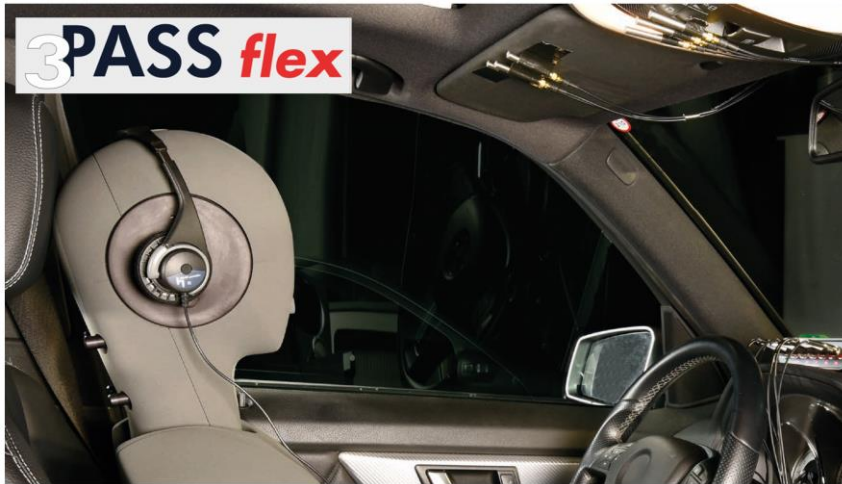
3PASS flex を用いた車載アプリケーションのカスタム マイクロホン 搭載例
