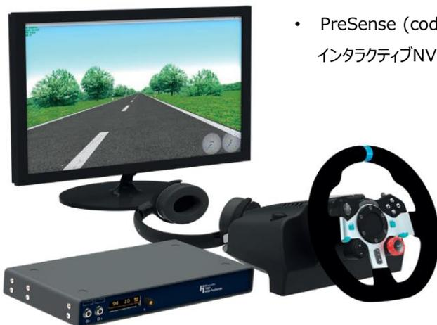
ステアリングホイール、ヘッドホン、PC 上のドライビングシミュレーター (ケーブルは省略してあります) で構成するデスクトップ型シミュレーション シナリオの HXB PreSense
