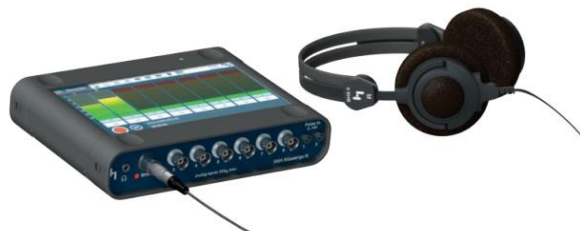
BHS端子に接続した BHS II バイノーラルヘッドセット
