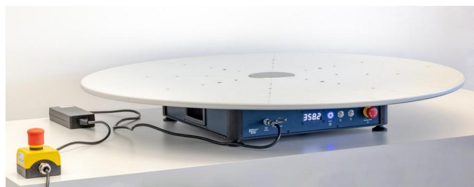
テストケースに多くの繰り返しステップが含まれる場合（例：各測定後に10°ずつ時計回りに回転等）、制御プログラムで測定とターンテーブルの動作を組み合わせることで、プロセスを完全自動化できます。
