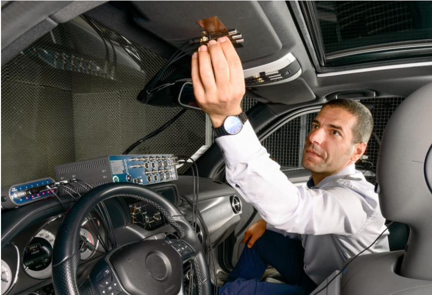
HEAD acoustics のエンジニアがマルチマイクロホン搭載のハンズフリー通話システムをイコライゼーションする為、測定マイクロホンを設置している様子
