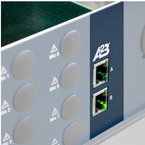
coreA2B, die neue Erweiterung für die mehrkanalige Hardwareplattform *labCORE*, ist eine leistungsstarke Lösung, um die Audioperformance auf der A<sup>2</sup>B-Bustechnologie zu testen.
