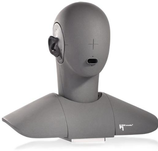
Hoheempfindliche Mikrofone in den Ohrsimulatoren erzielen ein sehr geringes Eigenrauschen von 16 dB<sub>SPL</sub>(A) des binauralen Kunstkopf-Messsystems HMS II.3-LN.
