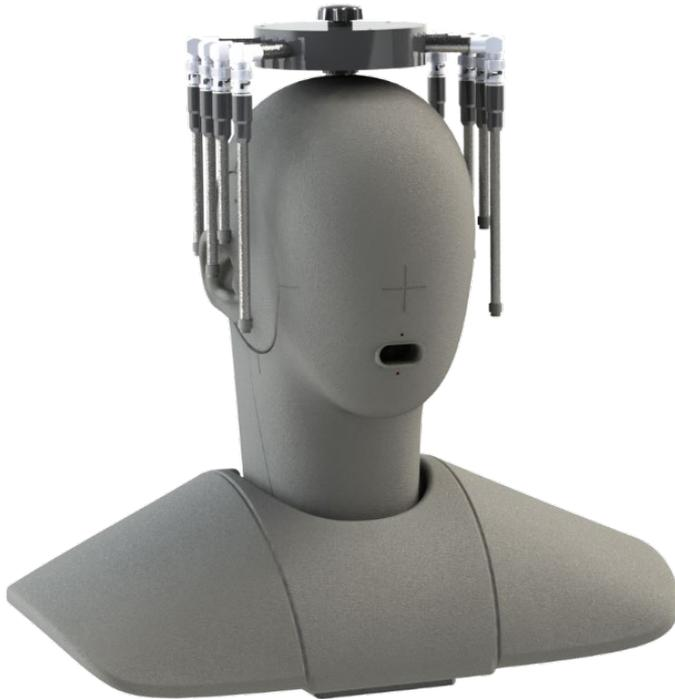
Das Mikrofon-Array MSA II montiert auf einem Kunstkopf-Messsystem wie HMS II.3 ermöglicht realistische Aufnahmen individueller Hintergrundgeräusch-Szenarien für Tests von ANC-Kopfhörer und Headsets.
