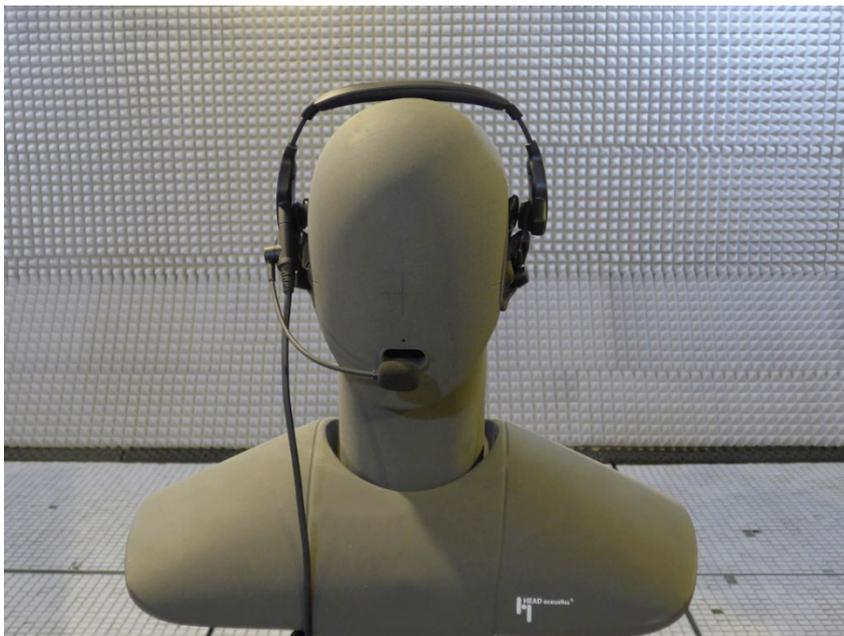
Hersteller von Piloten-Headsets können mit Hilfe eines Kunstkopf-Messsystems sowie HQS-ANC-Headset, der neuen Datenbank für das Kommunikations-Analysesystem ACQUA, die Sprach- und Audioqualität ihrer Geräte messen.
