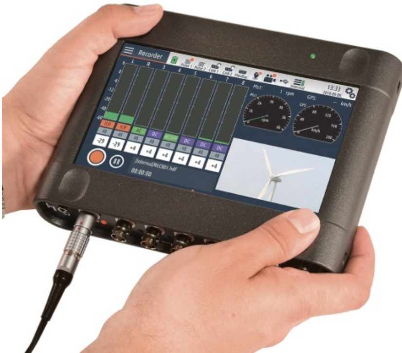
SQuadriga III: Handgehaltenes Messsystem mit Videofunktion
