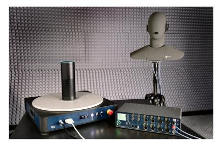
Mit *lab*CORE, HRT I und dem Kunstkopf-Messsystem HMS II.3 lassen sich z. B. Smart-Speaker testen.
