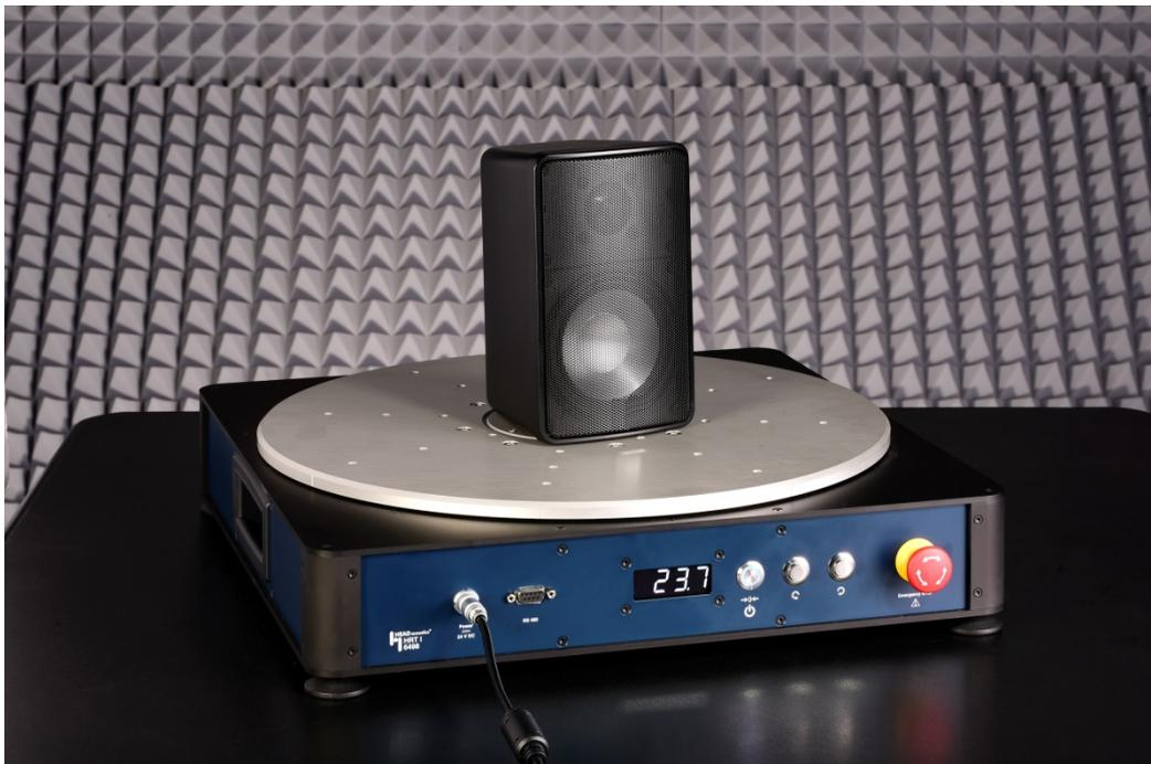
In Kombination mit dem Drehteller HRT I, messen Anwender die Richtcharakteristik von passiven und aktiven Lautsprechern.
