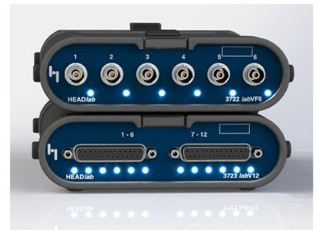
labV6 und labV12 sind Eingangsmodulare des HEADlab-Multikanal-Frontendsystems zur mobilen Datenerfassung.
