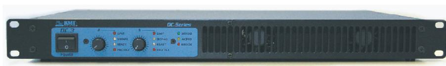
Die Endstufe DC 3 von KMT ist in Class-H-Technologie mit bipolaren Endtransistoren aufgebaut. Es lassen sich die Betriebsarten Fullrange, Top und Bass pro Kanal wählen. Die Trennfrequenz beträgt 120 Hertz mit 24 dB Flankensteilheit.
