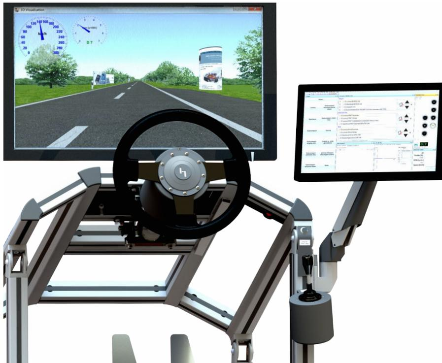
Für die komfortable Bedienung von H3S z. B. für das Umschalten zwischen Geräuschvarianten ist ein Touchscreen über einen Schwenkarm an der Bedienkonsole befestigt. Während der simulierten Fahrt kann H3S über einen großen, zentral hinter dem Lenkrad positionierten Bildschirm eine visuelle Szenerie darstellen sowie den aktuellen Fahrzustand in Form von Drehzahl und Geschwindigkeit anzeigen.
