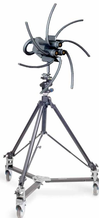
VMA II.1 ist mit wenigen Handgriffen sicher auf dem Stativ VMT I.1 montiert.
