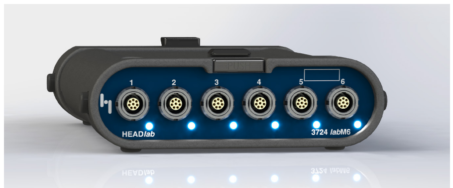
An das HEAD/lab-Modul labM6 können bis zu drei Kopf-Schulter-Einheiten HSU III.3 angeschlossen werden.
