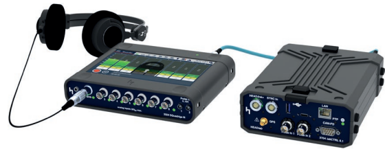
SQadriga III über die HEADlink-Schnittstelle mit einem HEADlab-Controller labCTRL II.1 verbunden
