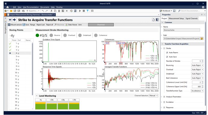
Das Messfenster bietet vier verschiedene Diagramme, die das Zeitsignal der Anregung, die Zeitsignale aller angegebenen Referenzpunkte, die Kohärenz und die Übertragungsfunktion anzeigen.
