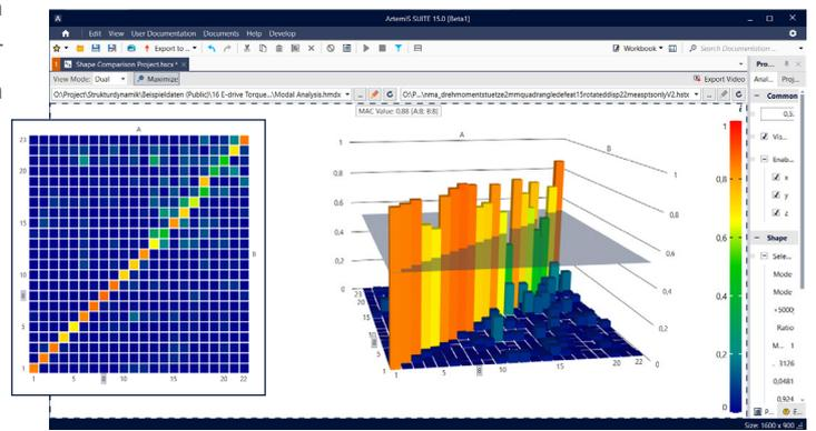
Im Eigenschaften-Tool-Fenster kann der Anwender die Option „Schwellenwert einblenden“ aktivieren. Daraufhin wird der Gruppen-Schwellenwert als teiltransparente Ebene eingeblendet, wodurch eine optische Gruppierung relevanter MAC-Werte möglich ist. Optional steht eine 2D-Ansicht zur Verfügung, die über das Kontextmenü aufgerufen werden kann.
