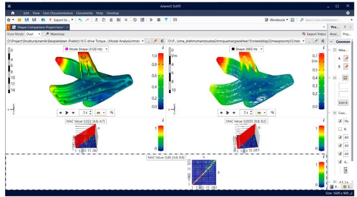
Zwei Ergebnissätze können anhand der MAC-Matrix miteinander verglichen werden. Hohe MAC-Werte (nahe bei 1) zeigen eine hohe Verformungskorrelation zwischen zwei Schwingungsformen an und sind daher ein hervorragendes Hilfsmittel, beispielsweise für die Modellaktualisierung.
