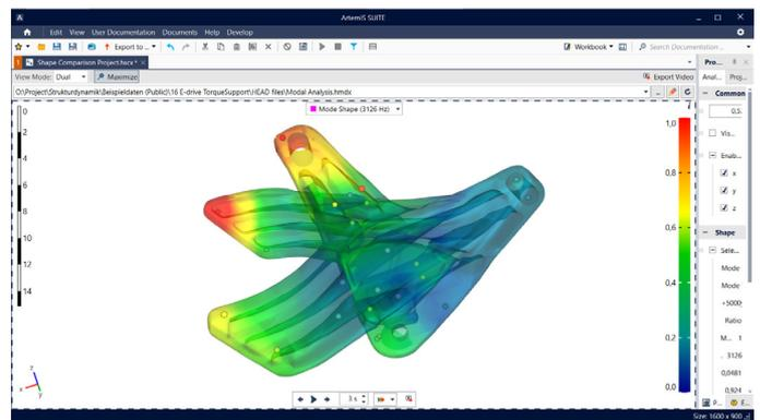
Mittels der 3D-Animationsdarstellung kann der Anwender auswählen, wie die Daten visualisiert werden sollen. Darüber hinaus lässt sich der Verlauf der Bewegung jedes Messpunktes in Form eines verblassenden Schweißes visualisieren.
