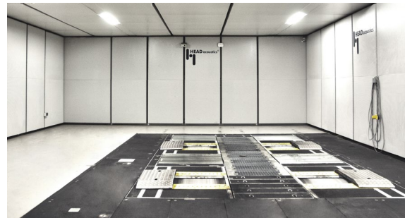
Rollenprüfstand der HEAD acoustics GmbH
