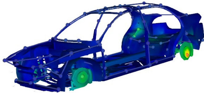
Betriebsschwingformen einfach visualisieren in ArtemiS SUITE
