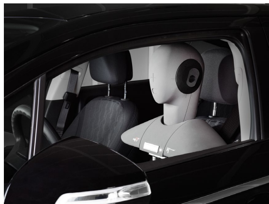
Beispiel für einen Empfängersensor: Kunstkopfmesssystem zur Durchführung einer BTPA
