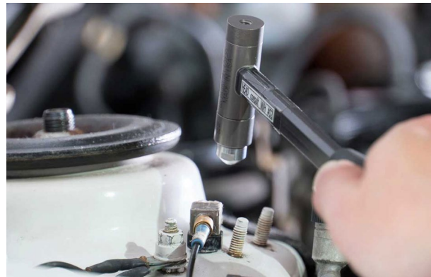
Bestimmung der Inertanz mit Impulshammermessungen
