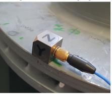
bringen von zusätzlichen Massen auf eine Struktur die Eigenfrequenzen in niedrigere Frequenzbereiche verschiebt. Der Gewichtseinfluss der Beschleunigungsaufnehmer darf nicht unterschätzt werden. Um diesen Effekt zu reduzieren, sollte die Sensormasse im Vergleich zur Masse der Struktur sehr klein sein. Weiterhin muss das Kabel des Sensors so verlegt werden, dass Störeinflüsse minimiert werden.
