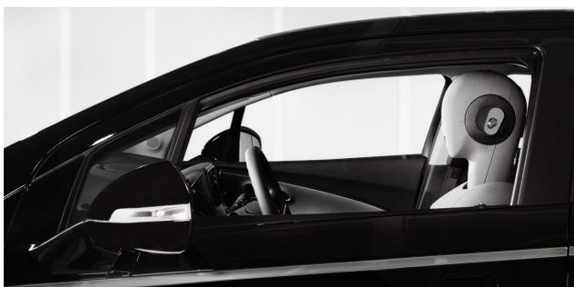
Im Gegensatz dazu enthält eine binaurale Aufnahme alle für die binaurale Signalverarbeitung wichtigen Informationen. Eine binaurale Aufnahme kann z. B. mit einem Kunstkopf aufgenommen werden. Ein Kunstkopf-Messsystem besteht aus einem künstlichen Kopf mit je einem Mikrofon im rechten und linken Gehörgang.
