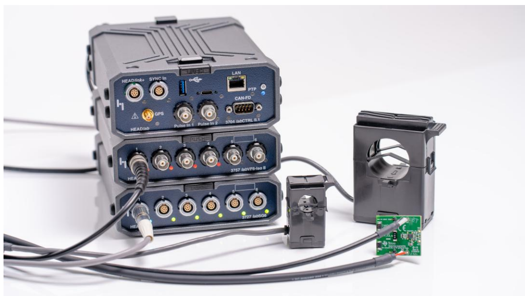
Abbildung 1: Induktive Stromsensoren oder Current Sense Amplifier können zur Strommessung an HEADlab-Modulen wie labVF6-Iso II und labSG6 genutzt werden
