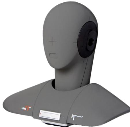
Abbildung 3: Kunstkopfmesssystem HMS IV
