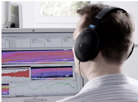
Außerdem hat die Aufzeichnung der Geräusche den Vorteil, dass zusätzlich zum Analysieren mit dem Gehör die Geräuschdaten auch rechnergestützten messtechnischen Analysen unterzogen werden können. Diese Kombination aus analysierendem Sehen und Hören optimiert die Geräuschdiagnose und erleichtert das gezielte Geräuschdesign.
