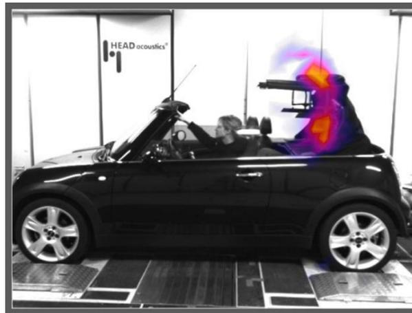
Abbildung 7: Schallquellenlokalisierung mithilfe des Beamformings
