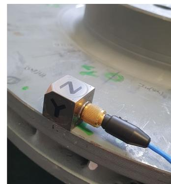
Abbildung 8: Beschleunigungsaufnehmer
